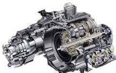
Cycle de changement : les transmissions DCT / DSG doivent impérativement être régénérées à temps, aux intervalles spécifiés par le fabricant. En règle générale, entre 60.000 et 120.000 km.
