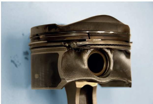
Kolv skadad av LSPI
