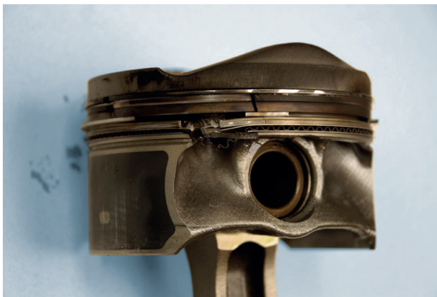
Piest poškodený v dôsledku LSPI
