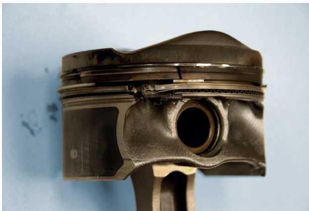
Поршень, пошкоджений LSPI
