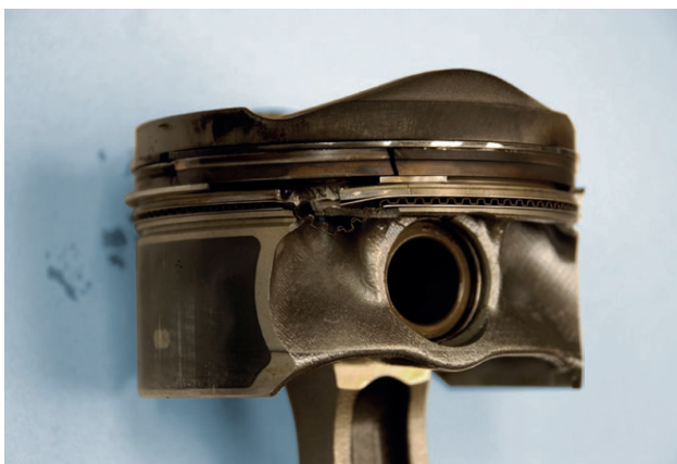
Piston endommagé par le LSPI
